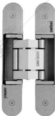
ES CONC 01 D80 NA Available : MATT BLACK Capacity (max) : 80 kg / pair Max. Door Width : 90 cm Opening Angle : \leq 150^\circ
