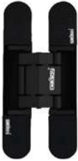
ES CONC 01 D40 MATT BLACK Available : NA Capacity (max) : 40 kg / pair Max. Door Width : 80 cm Opening Angle : \leq 150^\circ
